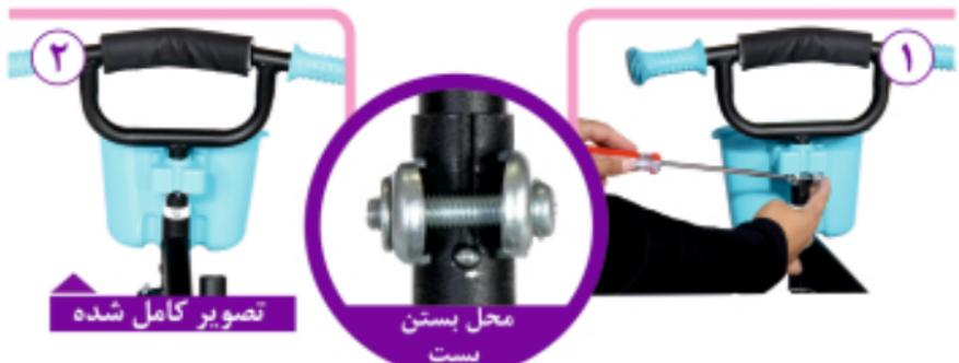
۵- محور چرخ عقب را مانند تصویر به شاسی متصل و سپس به وسیله آچار پیچ های آن را محکم نمایید. (دقت کنید نحوه قرار گرفتن محور چرخ عقب به شاسی باید طوری باشد که زبانه بلندتر به پروفیل شاسی و زبانه کوتاهتر به کمک فنر متصل شود.)
