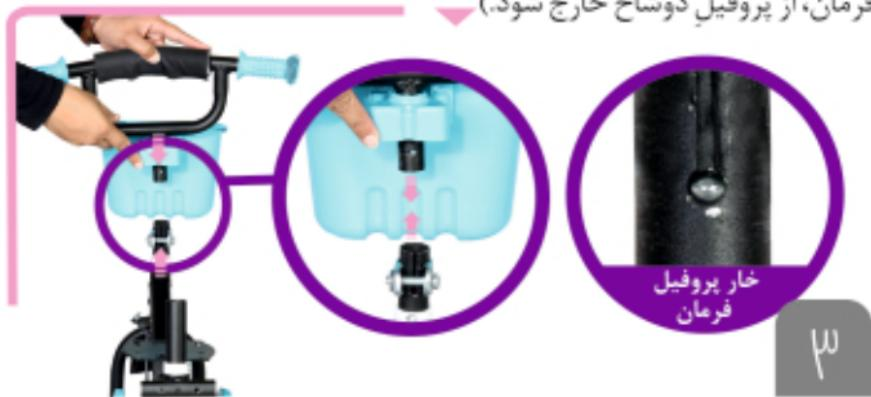
۴- پیچ بست
